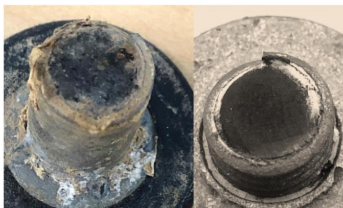
Figura 5 - Dois parafusos quebrados em serviço [acervo pessoal do professor André Paulo Tschiptschin]
