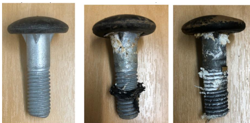
Figura 6 - Aspecto de três parafusos inteiros, respectivamente, sem uso e retirados dos tanques 2 e 3 [acervo pessoal do professor André Paulo Tschiptschin]
