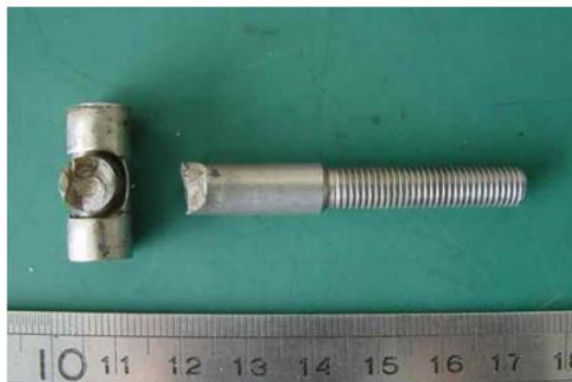
Figura 8 - foto do parafuso fraturado [1]
