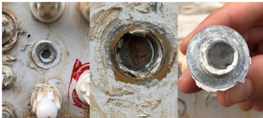
Figura 4 - Parafuso quebrado no costado do tanque [acervo pessoal do professor André Paulo Tschiptschin]
